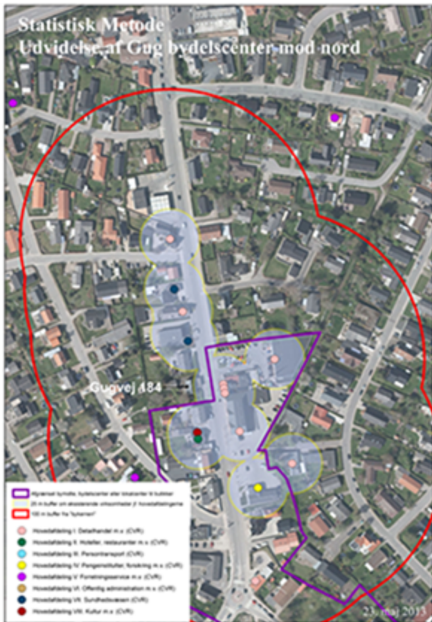
Den statistiske metodes muligheder for udvidelse af bydelsecentret i Gug (Lilla streg viser eksisterende afgrænset bydelscenter, gule cirkler er 25 m om hver produktionsenhed og rød amøbe er 100 m om faktisk bymidtekerne)
