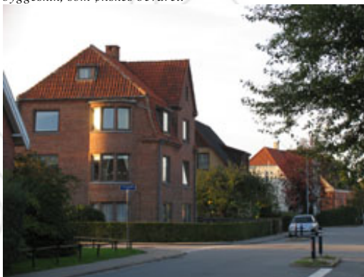
Der lægges vægt på at bevare "Kærbyhusenes" særlige karaktertræk: højtliggende kældre, høj trappe ved entrédøren, røde mursten, tegltage og afvalmede gavle.
